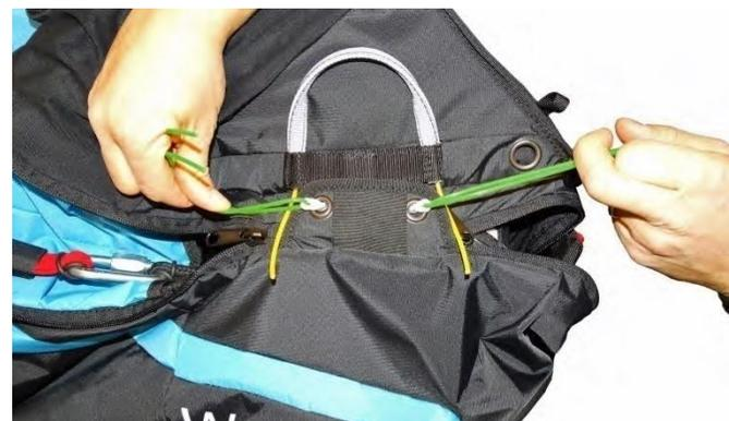
После закрывания всех частей отсека желательно проверить, чтоб две молнии под системой открывания отсека были правильно закрыты.
