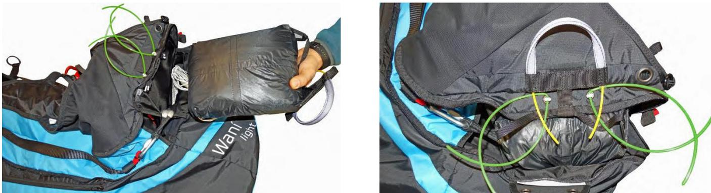
Сдвиньте застёжку молнии, закрывающей канал проводки фала спасательного парашюта, и застёжку молнии с другой стороны парашютного отсека к начальной точке под рукояткой спасательного парашюта. Закройте молнию с обеих сторон примерно на 20 см.
