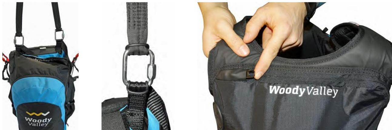
Два этих соединения должны быть выполнены с помощью резьбовых карабинов с прочностью на разрыв не менее 1400 кг. В любом случае важно убедиться, что длина фала достаточна для размещения спасательного парашюта внутри отсека подвески, и что имеется достаточный запас свободного хода, чтобы извлечь парашют из отсека, не вызывая самопроизвольного раскрытия спасательного парашюта при извлечении.
