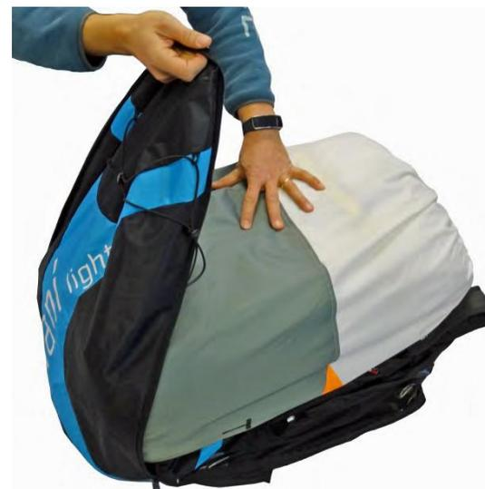
Поместите на парашют задний карман и, наконец, закройте рюкзак. Для облегчения закрытия застёжки-молнии, придавите рюкзак, чтобы удалить воздух, оставшийся внутри парашюта и подушки безопасности.
