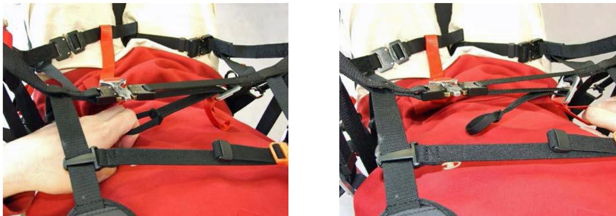
На подвеске есть еще упругая стяжка у края наплечников. Она предотвращает выскальзывание плечей из ремней во время старта и разбега. В пластиковый замок встроен полезный свисток, который может использоваться в чрезвычайных ситуациях.
