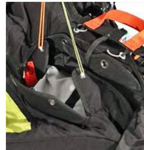
Протяните тонкие вспомогательные шнуры (например, из парашютной стропы) через каждую эластичную петлю. Это поможет закрывать отсек.
