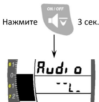
Нажмите на кнопку
