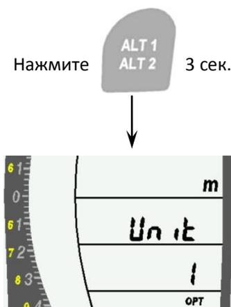
В режиме *Установки* ALT1 нажимайте кнопку
