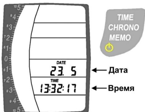
Когда прибор выключен, на дисплее отображаются дата и время.
