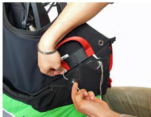
Вставьте металлические шпильки зачековки на рукоятке в эластичные петли под прозрачной плёнкой. После этого вспомогательные шнуры должны быть удалены, причем извлекаться они должны медленно, чтобы не повредить эластичные петли из-за чрезмерного трения между ними. В конце процедуры молния должна быть полностью закрыта, а поводок застёжки молнии находился под “кармашком” за левым плечевым ремнём.
