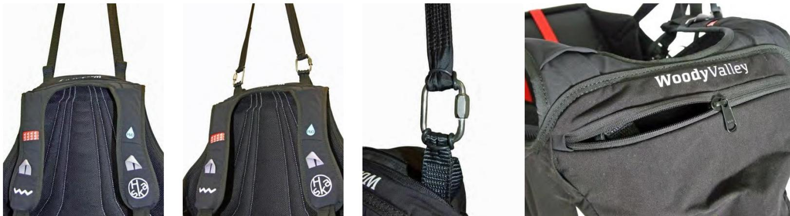
Два этих соединения должны быть выполнены с помощью резьбовых карабинов с прочностью на разрыв не менее 1400 кг. Важно убедиться, что длина фала достаточна для размещения спасательного парашюта внутри отсека подвески, и что имеется достаточный запас свободного хода, чтобы извлечь парашют из отсека, не вызывая самопроизвольного раскрытия спасательного парашюта при извлечении.
